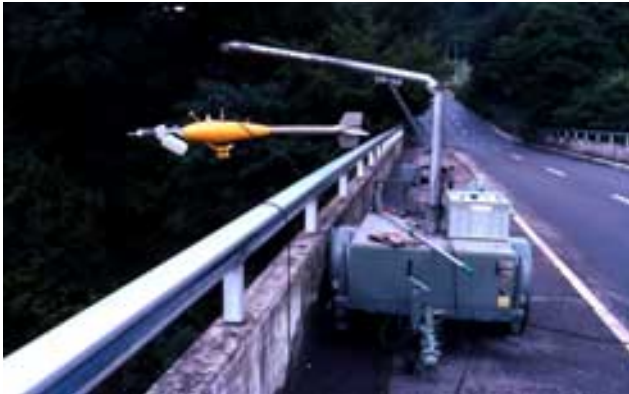
Fig. 8-2: Schwebstoffmesswagen der Landeshydrologie – Schwebstoffmessgerät am Flügelgewicht.
