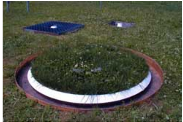
Fig. 4-6: Lysimeter und zwei bodeneben installierte Niederschlagsmesser (Hintergrund) im hydrologischen Testgebiet Rietholzbach (SG) der ETHZ.
