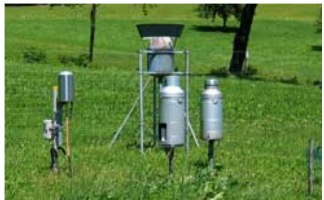
Fig. 2-6: Niederschlagsmessgeräte im hydrologischen Testgebiet der ETHZ (Rietholz bach, SG); von links nach rechts: Pluviograph (nach Joss-Tognini), Pluviometer (Jahrestotalisator nach Mougins mit Windschutzring), Pluviograph (Belfort-Waage, analoge Datenaufzeichnung), Pluviograph (Belfort-Waage, digitale Datenaufzeichnung).
