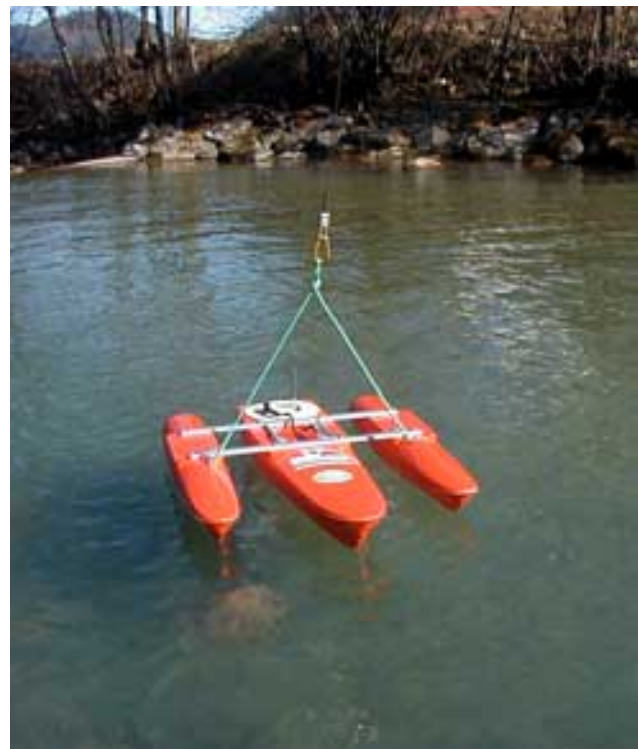
Fig. 5-9: Trimaran-Schwimmkörper mit Akustik-Doppler-Messgerät (ADCP).
