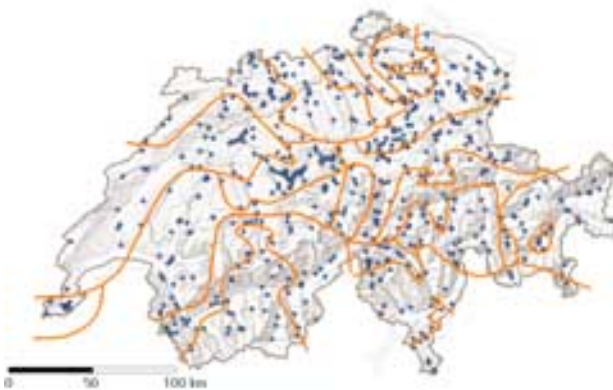
Fig. 5-26: Hochwasserregionen der Schweiz und Lage der beobachteten Hochwasserabflüsse aus Fig. 5-25 (nach KAN 1995).
