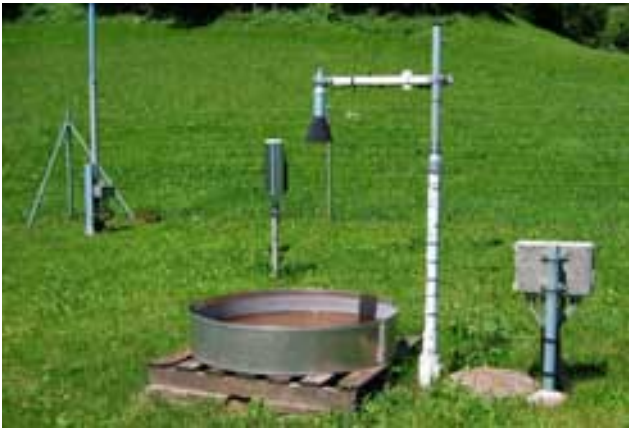
Fig. 4-4: Evaporimeter (Class A Pan) mit Niederschlagsmesser Ott-Pluvio (Hintergrund) im hydrologischen Testgebiet Rietholzbach (SG) der ETHZ.
