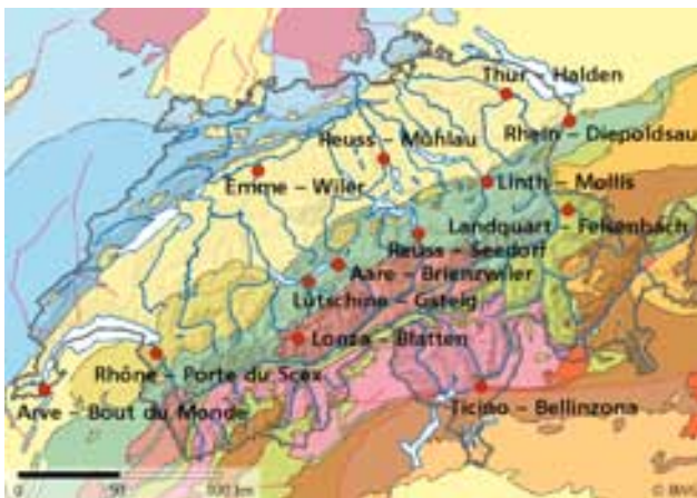
Fig. 8-7: Standardmessnetz der Landeshydrologie zur Erfassung der Schwebstoffe in Fließgewässern. (Für die Beschriftung der geologischen Übersichtskarte s. Fig. 8-9) (Daten: BWG).
