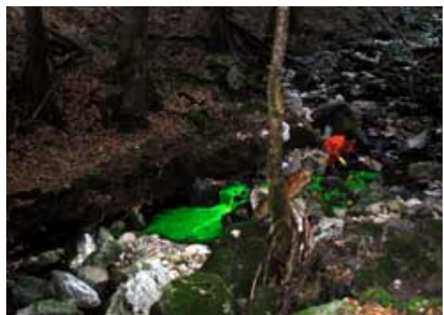
Fig. 7-20: Markierversuch in einem Karstsystem, Covatanne-Schlucht (VD).
