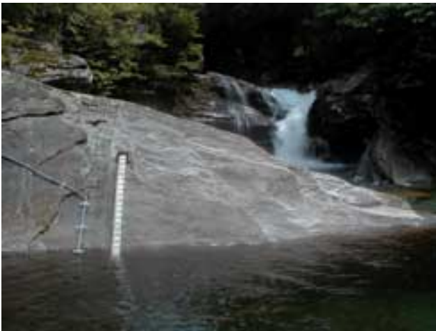
Fig. 5-3: Lattenpegel, Riale di Pincascia – Lavertezzo (TI).
