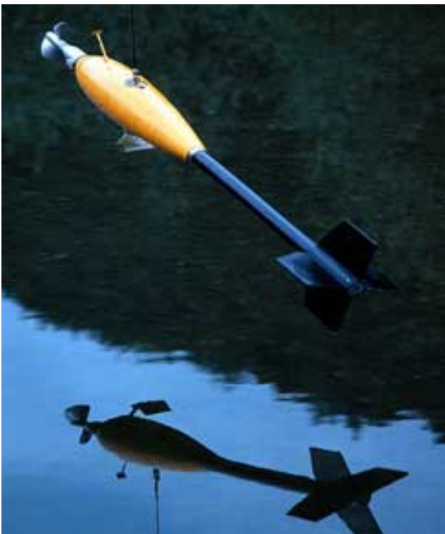
Fig. 5-7: Hydrometrischer Flügel an einer Seilflügelanlage.
