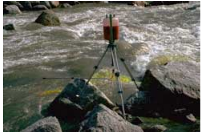
Fig. 5-11: Verdünnungsverfahren: Einspeisung eines Fluoreszenztracers mit der Mariott'schen Flasche.
