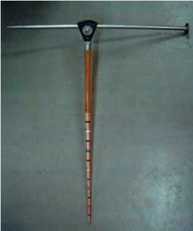
Fig. 5-10: Jensstab: Aus dem Wasserdruck auf den Stab kann die mittlere Fließgeschwindigkeit abgeleitet werden.
