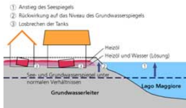
Fig. 7-26: Hochwassersituationsskizze Locarno, Oktober 2000 (nach DUPASQUIER & PARRIAUX 2002).
